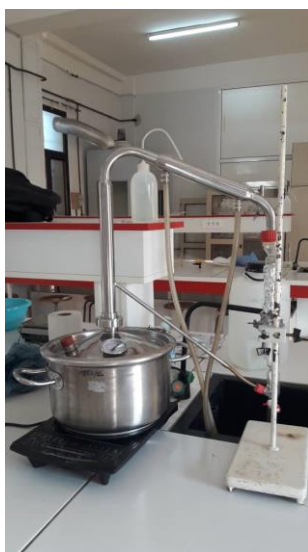
Figure 13 : extraction des huiles essentielles d' Artemisia campestris par l'entraînement à la vapeur d'eau
