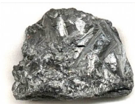
Figure 05 : Photo du manganèse sous forme minérale extrait d'un minerai. Daoust, 2012
