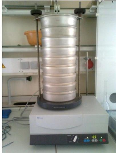
**Figure N° 16 : Tamis mécanique (le: 08/05/2014 photo prise par Lazergui.H)**
