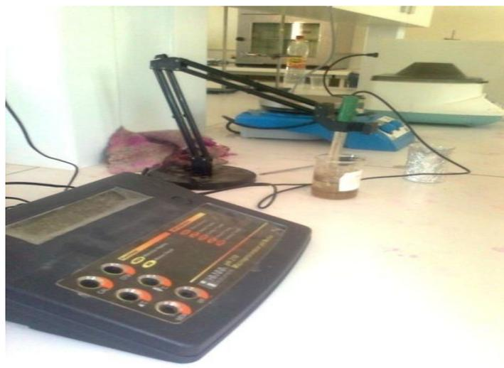
**Figure N° 19 : PH mètre(le: 08/05/2014 photo prise par Lazergui.H)**
