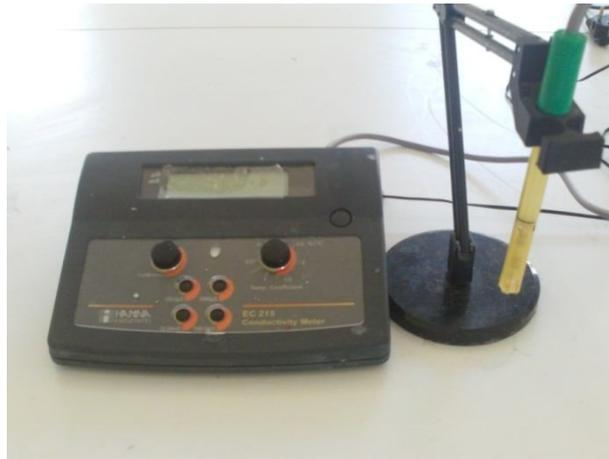
**Figure N°20 : conductivité mètre (le: 08/05/2014 photo prise par Lazergui.H)**
