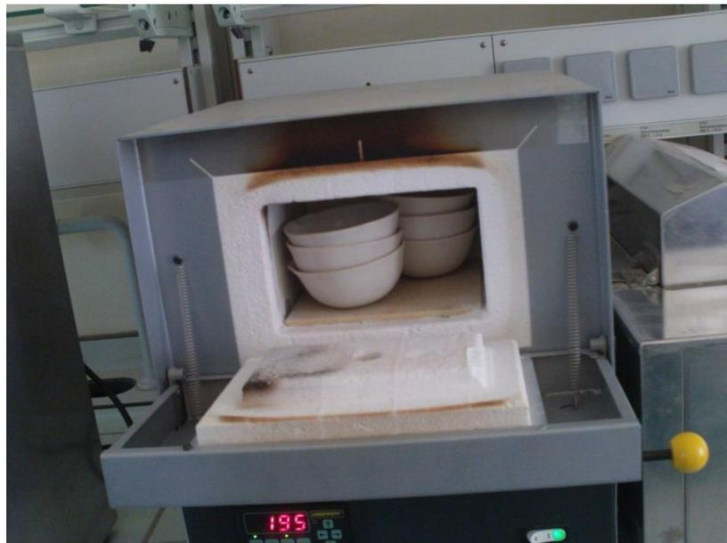
**Figure N° 18 : Four à moufle.(Le: 08/05/2014 photo prise par Lazergui.H)**
