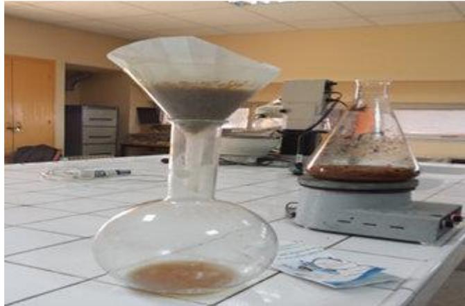
**Figure N°11** :Extraction par macération dans l'eau. (**Hadrich et al., 2014**)
