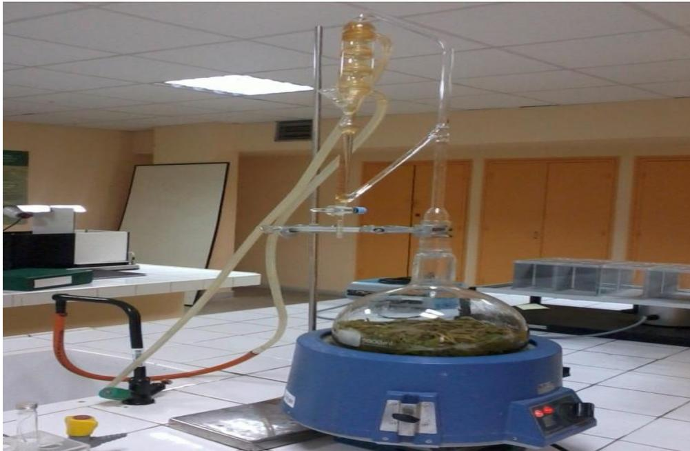
**Figure N°10 : Montage d'Hydrodistillation de la plante (Clevenger) (Chanthaphon et al., 2008)**
